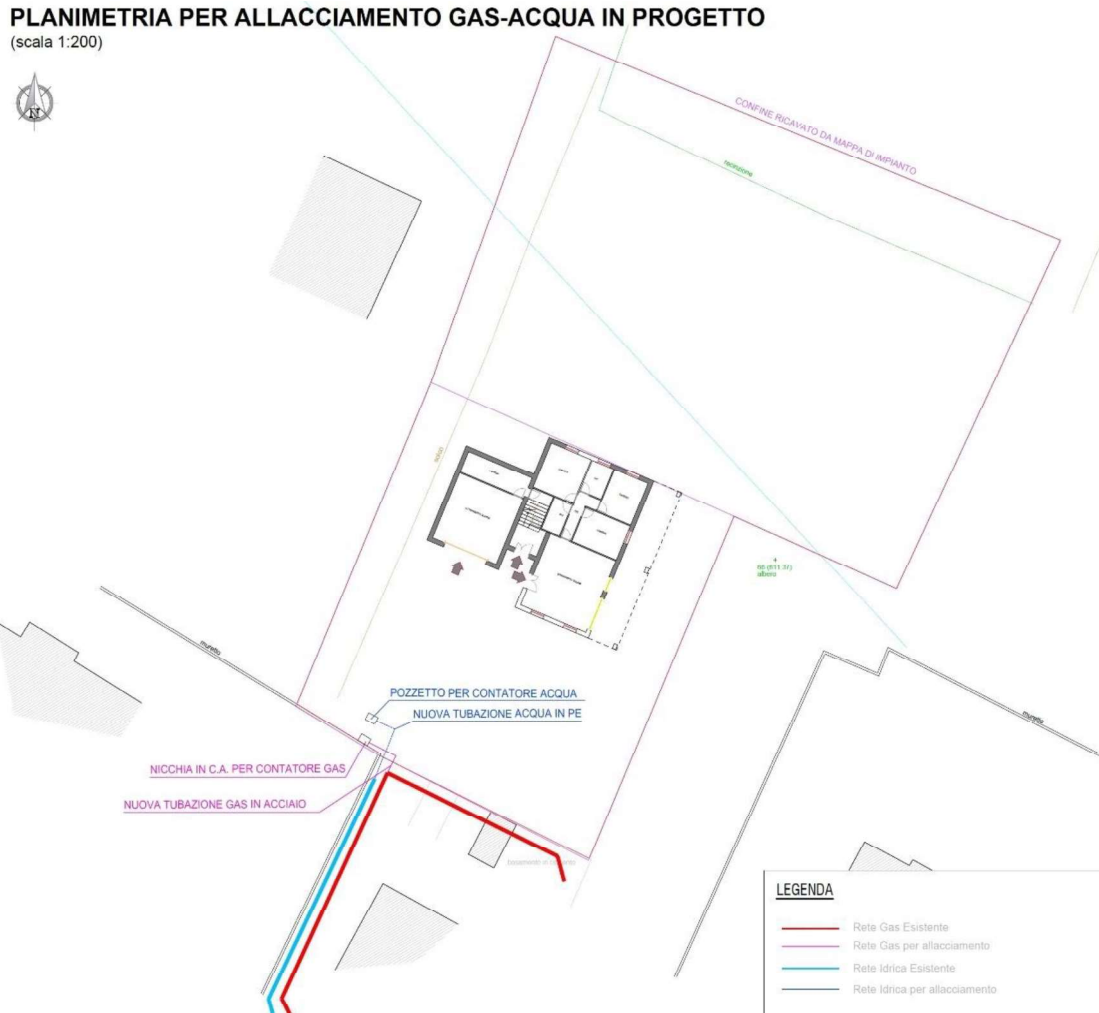
Figura 13: Planimetria per l'allacciamento Gas-Acqua in progetto (stralcio Tav. 06)
