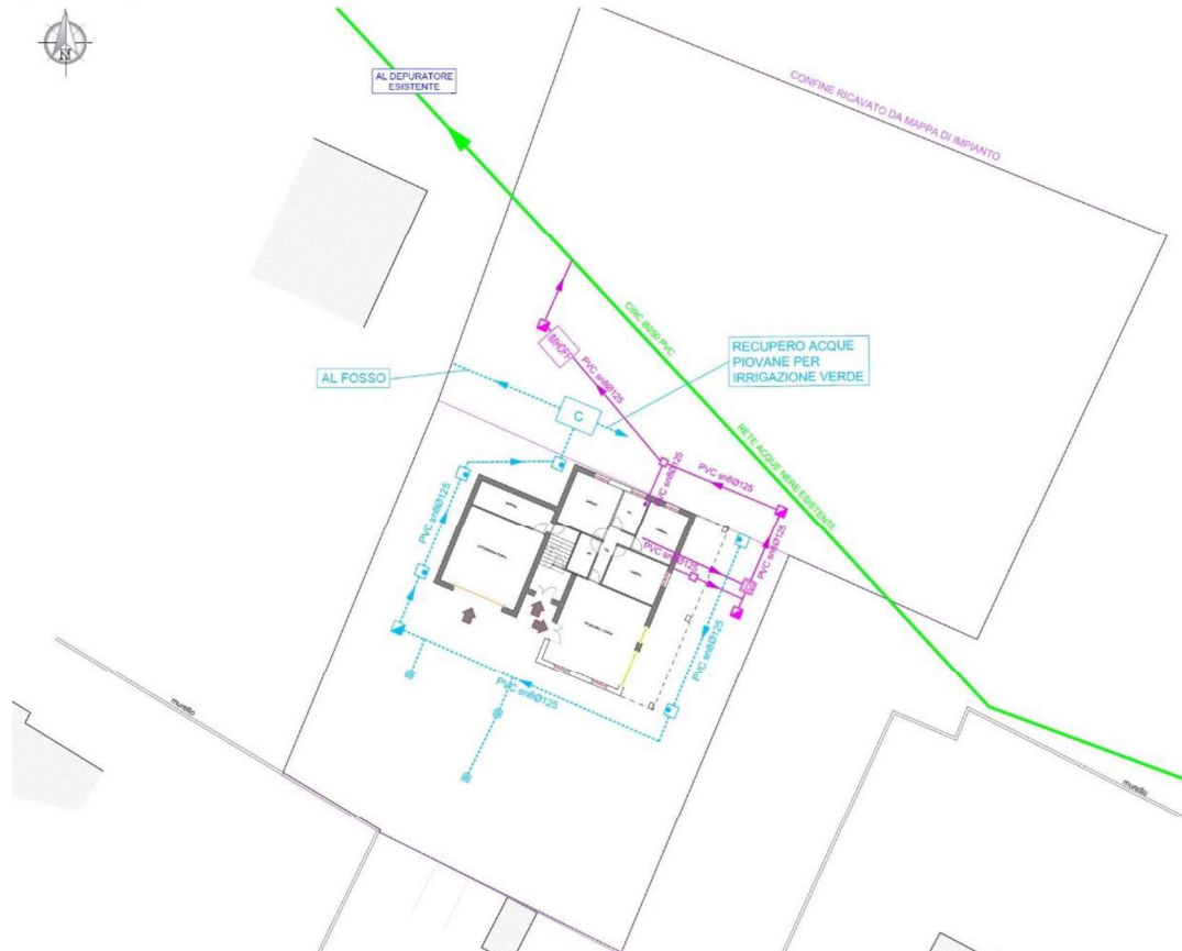
Figura 14: Planimetria con schema di smaltimento acque nere e bianche (stralcio Tav. 05)
