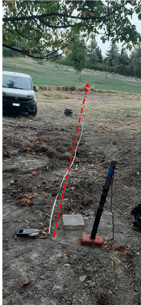
Piazzamento indagine MASW
